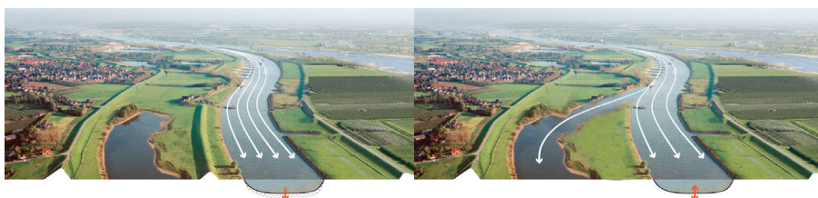
▲ Concept meestromende geul bij gemiddelde afvoeren, waarmee afvoer wordt afgeleid uit de hoofdgeul: links de huidige situatie, rechts de situatie met geul. (Bron: Stroming).
