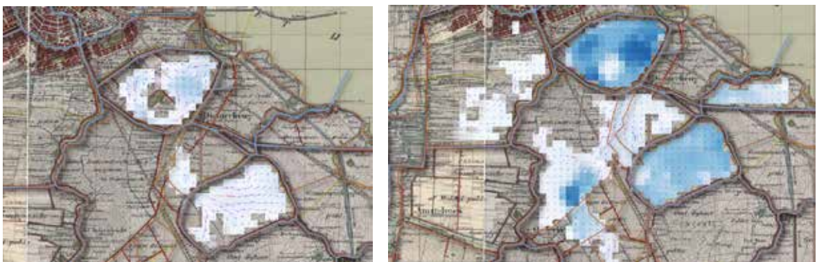
Afb. 9 Links: 19 juni 1672. Rechts: 22 juni 1672. De blauwe kleuren geven waterdiepte aan, met donkere kleuren een grotere waterdiepte. De pijlen geven stroomsnelheid aan: hoe groter de pijl, des te groter de stroomsnelheid. De rode stip in de rechthoek geeft de locatie aan van een schans, een verdedigingswerk dat is gebouwd aan een verhoogde toegangsweg door de waterlinie.
