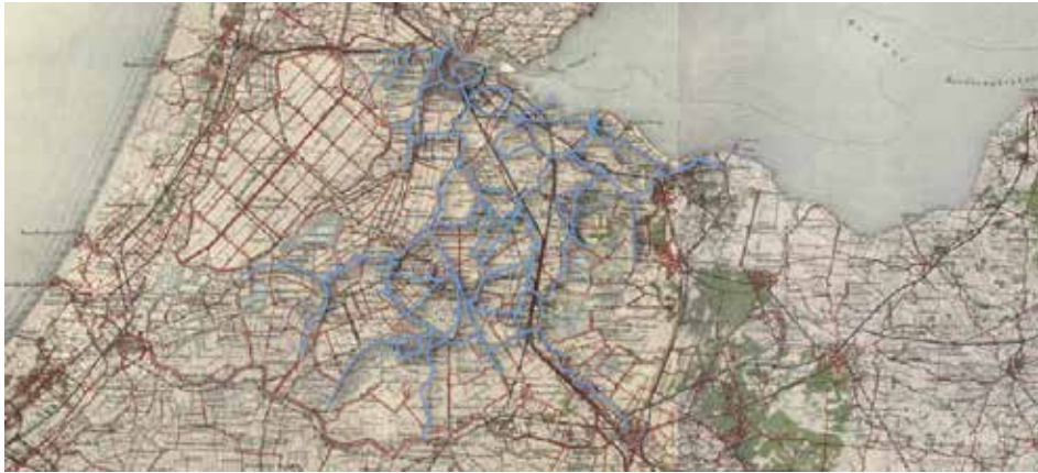
Afb. 7 Boven de watergangen uit 1672, geprojecteerd op een kaart van Nederland uit 1925. Via deze watergangen wordt het water door het systeem getransporteerd. Onder de dijken (bruin) die de watergangen scheiden van de polders (kruispatroon).
